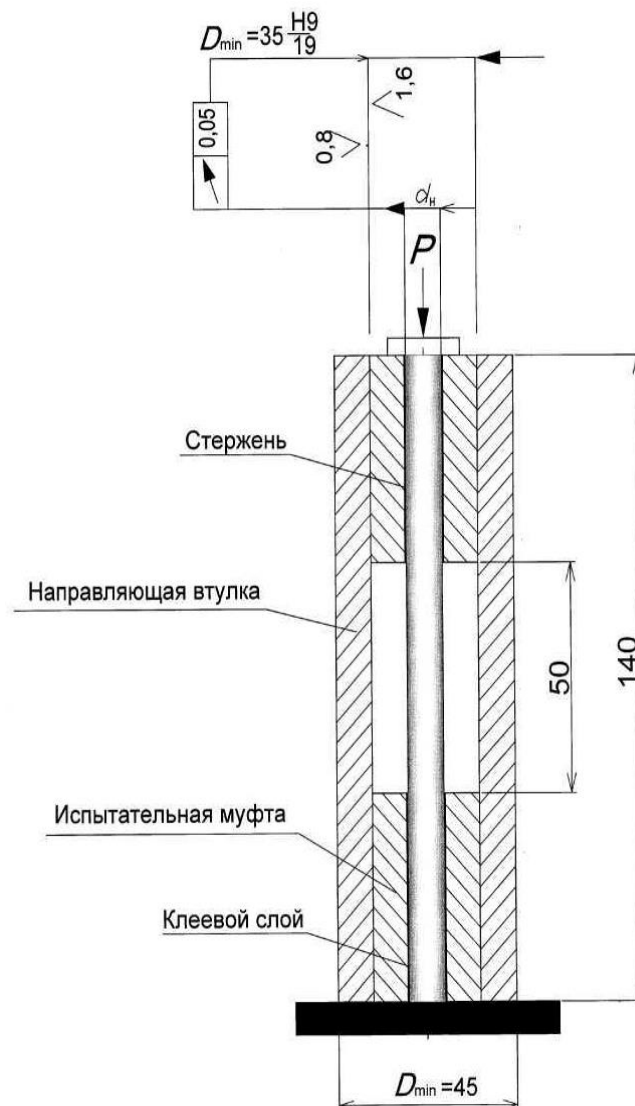
Рисунок В.2 – Приспособление для испытания образцов на сжатие
